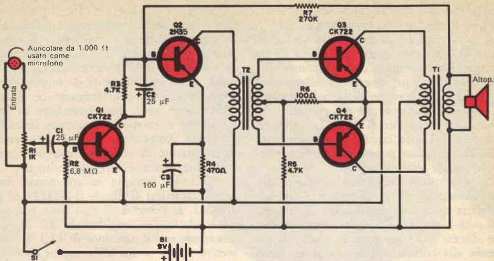
Fig. 4 - Circuito tipico di amplificatore BF adatto per scopi dimostrativi. Nella foto a destra è illustrato il montaggio sperimentale.
