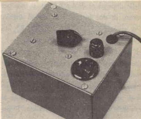
**Costruzione** - Nel costruire il dispositivo in questione è assolutamente indispensabile usare le debite precauzioni isolando tutti i componenti dalla scatola metallica esterna.
