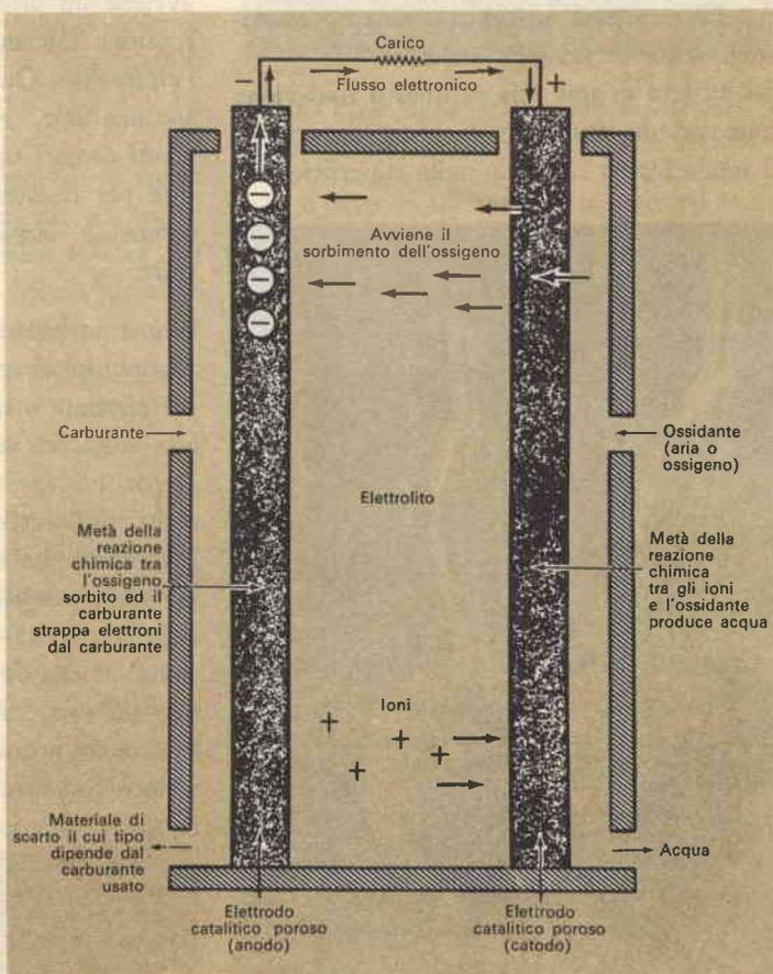
Questo disegno schematico illustra il funzionamento base delle pile a carburante. L'elettrolito può essere liquido, fluido o solido; gli elettrodi possono essere di carbone, di plastica, o di borato di platino o nichel in combinazione. Il tipo di carburante dipende in gran parte dal tipo di elettrodi usati; l'idrogeno reagisce con molta facilità ma attualmente, in seguito ai perfezionamenti apportati agli elettrodi, si usano economici idrocarburi.
