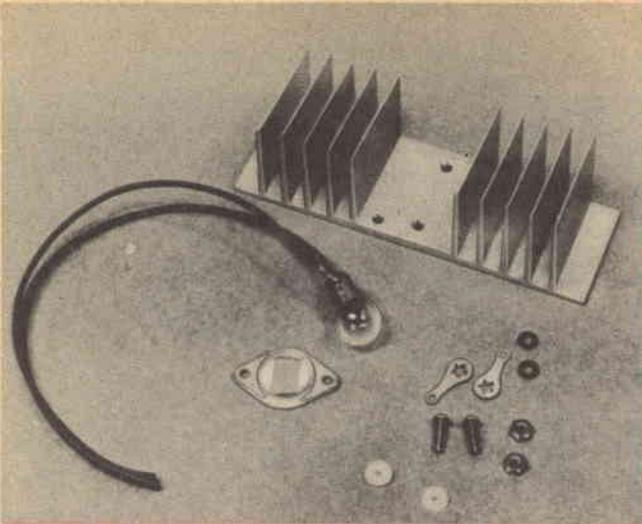
A sinistra si vedono le parti sciolte che devono essere montate sul radiatore. Si noti che non è necessario usare un portalampada: i fili possono essere collegati direttamente alla lampadina.
