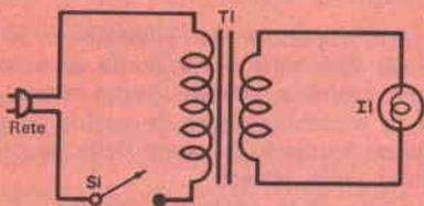
Il circuito è molto semplice e può essere realizzato senza alcuna difficoltà. Tutti i collegamenti devono essere saldati e quelli del trasformatore devono essere isolati con nastro adesivo o tubetto isolante.
