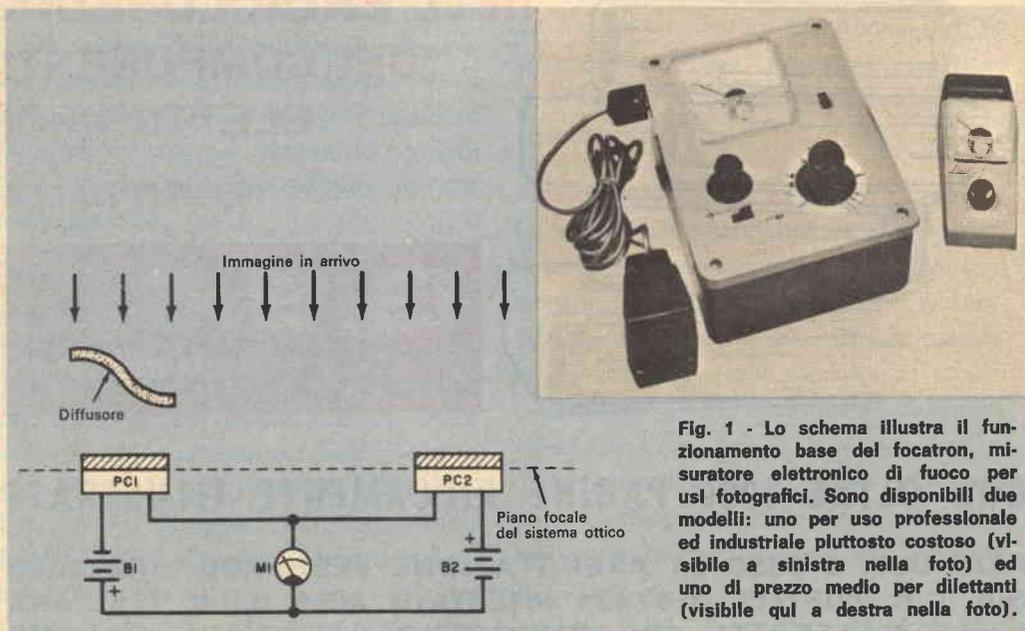
**Fig. 1** - Lo schema illustra il funzionamento base del focatron, misuratore elettronico di fuoco per usi fotografici. Sono disponibili due modelli: uno per uso professionale ed industriale piuttosto costoso (visibile a sinistra nella foto) ed uno di prezzo medio per dilettanti (visibile qui a destra nella foto).
