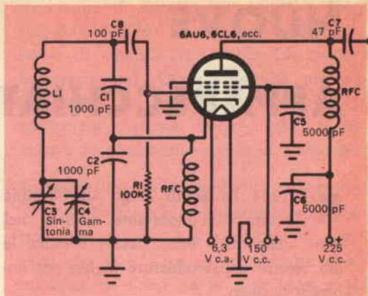
oscillatore Clapp una buona stabilità dinamica in frequenza.
