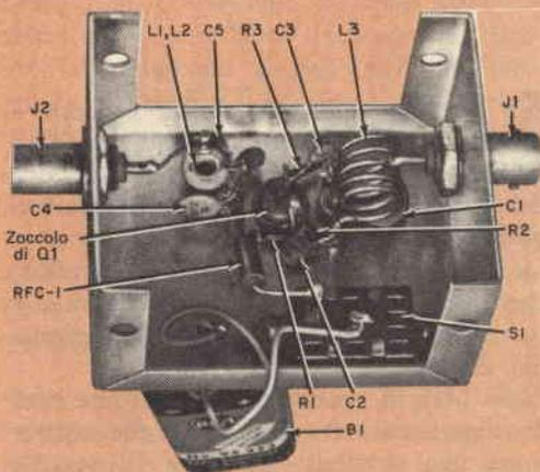
parte superiore della scatola. Il primario (L1) è composto da otto spire. Le bobine si avvolgono nella stessa direzione; i terminali superiori si collegano rispettivamente al collettore di Q1 ed a J2. Entrambe le bobine si avvolgono su un supporto con nucleo adatto per VHF.
