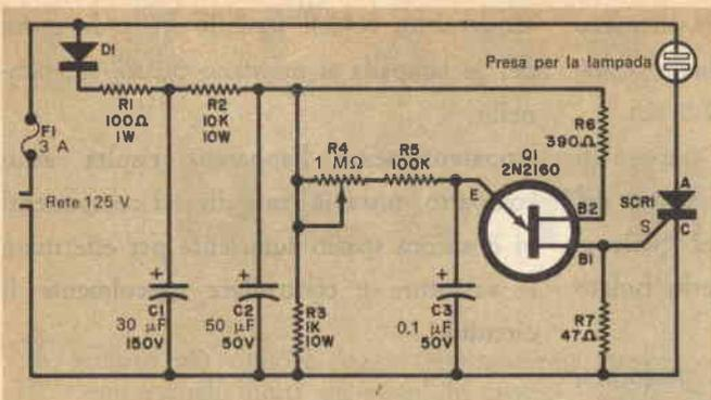
Montando l'apparecchiatura si deve aver cura di isolare tutte le parti dalla scatola metallica esterna.
