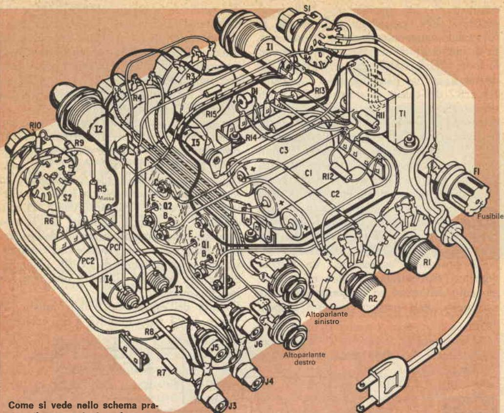
Come si vede nello schema pratico, il montaggio è molto compatto. Per un montaggio più comodo si può usare una scatola in bachelite od un telaio metallico di dimensioni maggiori
