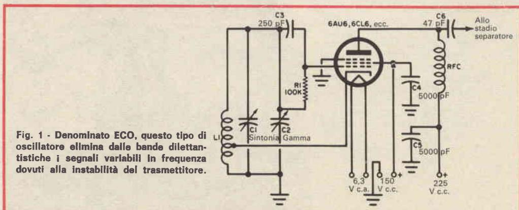
Fig. 1 - Denominato ECO, questo tipo di oscillatore elimina dalle bande dilettantistiche i segnali variabili in frequenza dovuti alla instabilità del trasmettitore.
