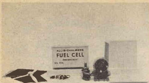
**Ecco i componenti necessari per costruire un modello funzionante, adatto per dimostrazioni scolastiche; per questo dispositivo viene usato come carburante alcool, sodio o idrossido di potassio e come ossidante perossido di idrogeno. Nel serbatoio, al centro della foto, sono situati gli elettrodi di platino, argento e nichel. Gli elettrodi terminali vanno collegati al piccolo motore elettrico.**
