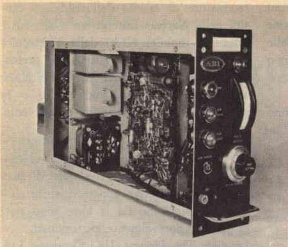
Ecco un indicatore di temperatura tipo FNC61A adatto per sistemi di sicurezza in reattori nucleari. L'unità fornisce in uscita un segnale di allarme se il segnale in entrata proveniente da una termocoppia supera un valore predeterminato.
