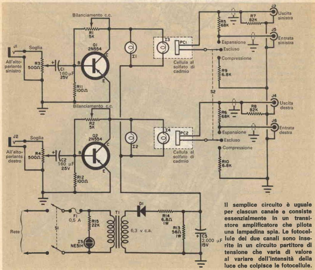
Il semplice circuito è uguale per ciascun canale e consiste essenzialmente in un transistor amplificatore che pilota una lampadina spia. Le fotocellule dei due canali sono inserite in un circuito partitore di tensione che varia di valore al variare dell'intensità della luce che colpisce le fotocellule.
