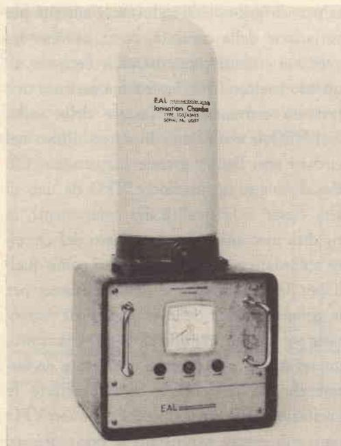
Il rivelatore di radiazioni gamma tipo N103, realizzato dalla Electronics Associates Ltd., è fisso e resistente alle intemperie; indica il livello della radiazione e mette in funzione l'allarme quando viene superato un certo livello.
